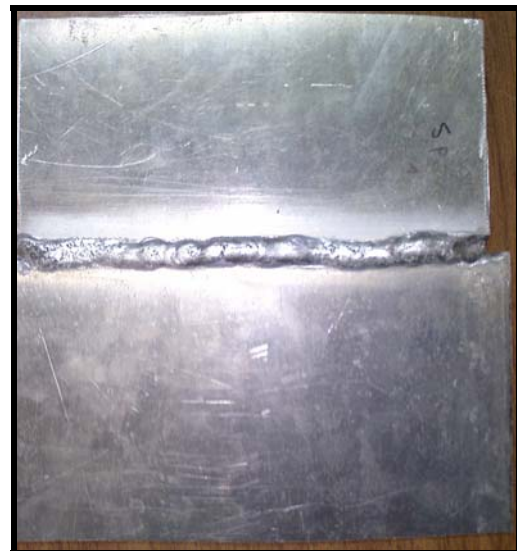
Figure-3. MIG welding.
