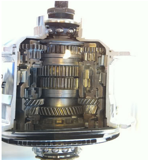
Figure-4. The Shimano Alfine 700 [17].
